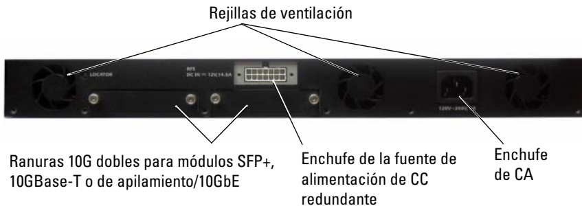
Ilustración 1-9. Panel posterior de PC7024P y PC7048P
