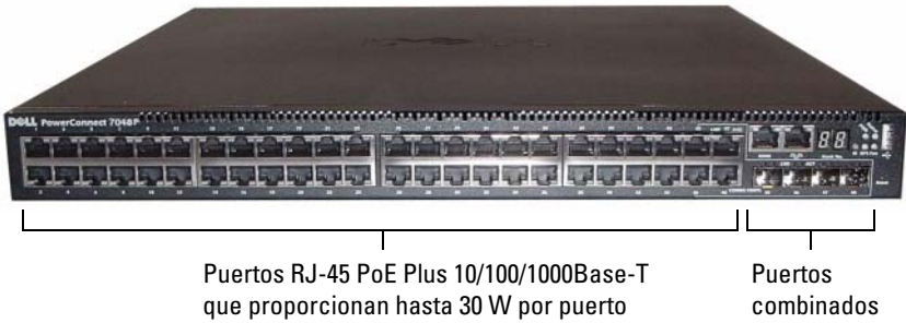
Ilustración 1-5. PowerConnect 7048P con 48 puertos PoE Plus 10/100/1000Base-T
