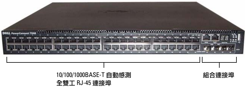
圖 1-4. PowerConnect 7048，具有 48 個 10/100/1000BASE-T 連接埠
